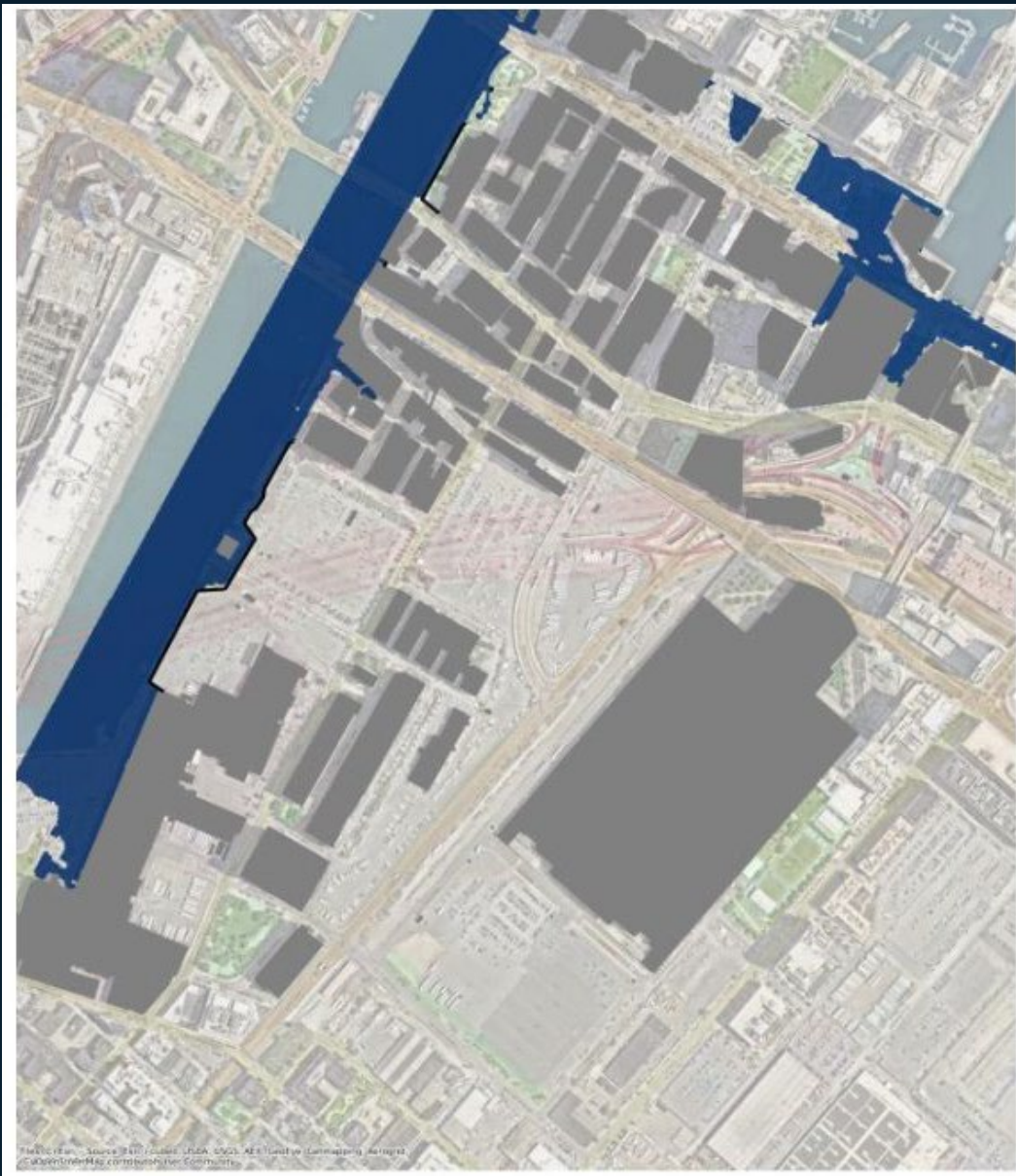
在現有條件下 以及完成擬建防護堤後 的2030年100年一遇風暴期間的 洪水範圍
